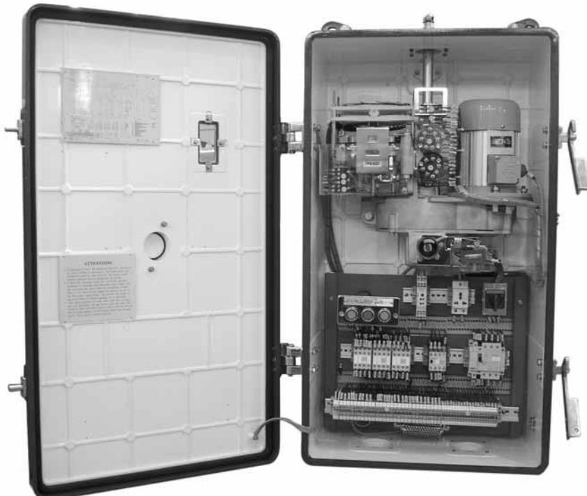
**Рис. 1 Внутренняя конструкция моторного привода.**
