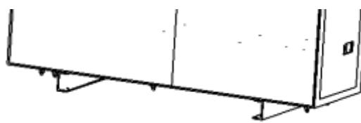
Рис. 6.2. Подъём погрузчиком за дно шкафа
