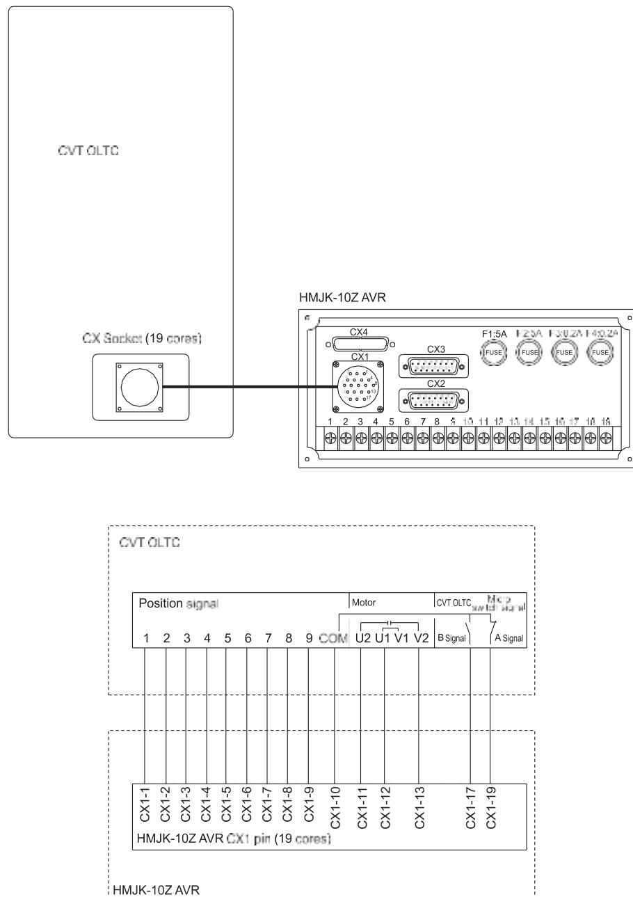
Примечание: Для более детального изучения ознакомьтесь с инструкцией регулятора напряжения HMJK-10Z
